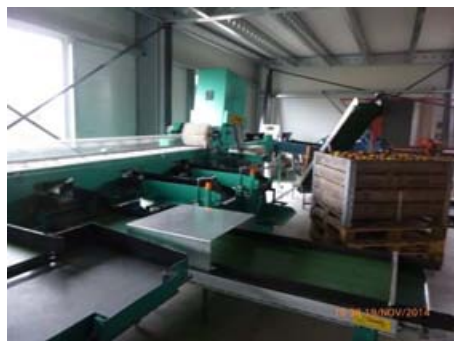
Abb. 5 Übliche Apfelsortieranlage mit Bürste
